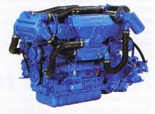
Cchon bei niedrigen Drehzahlen in Marschfahrt zu kommen und damit schneller in die Gleitphase zu kommen verspricht der neue Nanni Diesel mit 100 PS (73,6 kW). Auf Kubota Basis verfügt der 3-Liter-Motor mit vier Zylindern über eine Direkteinspritzung, die nicht nur die Leistungsausbeute erhöht, sondern auch den Rußausstoß stark senkt. Zwei Balancewellen sorgen zusätzlich für die nötige Laufruhe. Kontakt: IMS, Tel: 0461 3188130, 24941 Flensburg. www.nannidiesel.de
