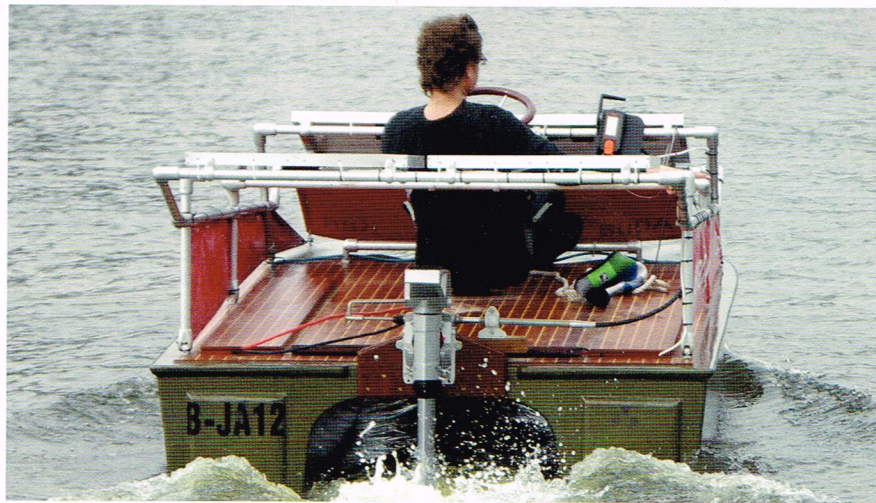
Von achtern ist die Halbgleiterwelle zu erkennen, der Tragflügel hebt die Rümpfe um etwa 15 bis 30 cm an.
